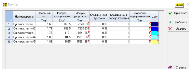
Рис. 5. Параметры грунтов, вводимые в программу – сателлиту КРОСС
